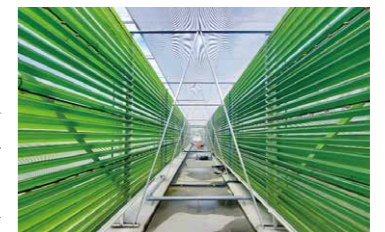
ガラスチューブ型フォトバイオリクターによる培養 熊谷組様プレスリリース記事より引用
